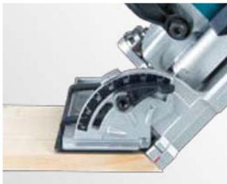
La guía de ángulo ajustable puede ser fijada en cualquier posición entre 0° y 90° con puntos prefijados a 0°, 45° y 90°.
