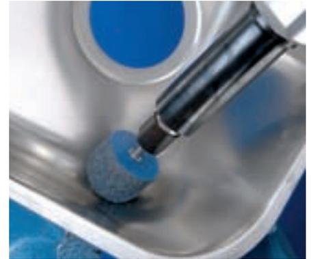
Las herramientas de estructurado Poliflex® son especialmente adecuadas para el mecanizado de piezas de acero fino (INOX). El aglomerante PUR está mezclado homogéneamente y tiene alto contenido de grano abrasivo intercalado.
