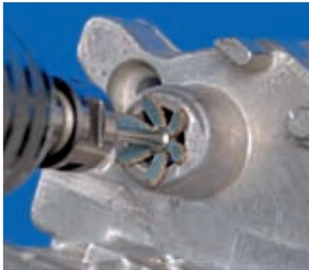
Herramientas flexibles para trabajar las superficies interiores de orificios y tubos.
