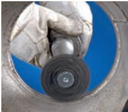
PCLICLEAN® es un vellón abrasivo macroestructurado para limpieza que resulta de una combinación especial de fibras sintéticas y grano abrasivo.
