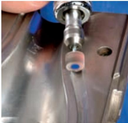
Las láminas de lija se montan de forma radial alrededor del eje de la herramienta. Gracias a su flexibilidad se adaptan a todos los perfiles de la pieza de trabajo. El soporte de la lija de cada lámina es de tela resistente al desgarro con aglomerante de resina sintética.
