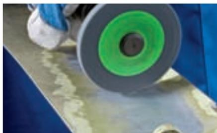
Las ruedas compactas de amolar POLINOX® PNER están compuestas de láminas de vellón muy comprimidas y unidas con resina por un sistema muy especial. Las herramientas de vellón así fabricadas logran excelentes acabados de superficie, tienen gran capacidad de arranque de material y larga duración. Flexibilidad media en el trabajo de metales blandos, con aleaciones, aceros de alta aleación y aleaciones de titanio.
