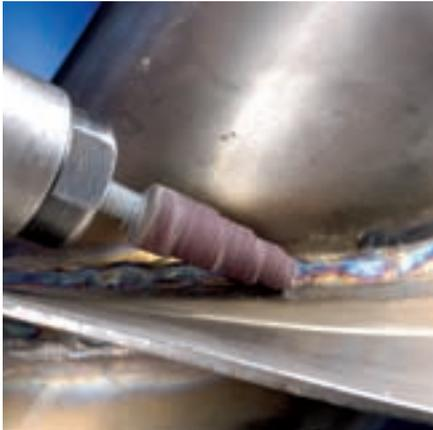
Los POLIROLL® y POLICO® se confeccionan con lija abrasiva enrollada en forma de espiral. El soporte de la lija es un tejido resistente en el que se incrusta el grano abrasivo y se recubre con resina sintética logrando así un lijado de máximo rendimiento.
