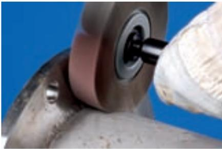
Las láminas de lija van montadas de forma radial alrededor del eje de la herramienta. Se adaptan a todos los perfiles de la pieza a trabajar logrando simultáneamente un lijado de resaltes y hendiduras de la pieza. El soporte de cada lámina de lija es de tela resistente al desgarrar con aglomerante sintético. Los abanicos de núcleo se denominan en la ISO 5429 "discos de láminas lijadoras".
