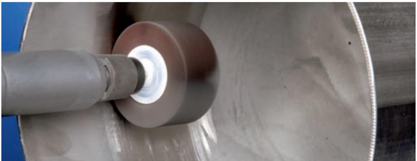
Para lijado agresivo con máximo rendimiento de arranque en materiales duros y malos conductores del calor.
