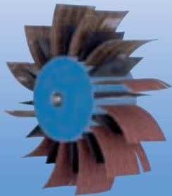
El abanico lijador POLIFLAP® se compone de un cuerpo soporte con mango de 12 mm de  $\varnothing$  y láminas de goma entre las cuales se colocan las láminas lijadoras. La combinación y disposición de las láminas de lija y de goma confiere a la herramienta una gran flexibilidad.
