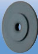
La brida de reducción se puede utilizar para la fijación de abanicos de núcleo PFERD. El agujero de la brida se puede taladrar en función de la medida del correspondiente husillo de la máquina. La brida de fijación está construida de tal forma que se encuentra avellanada dentro de la herramienta.
