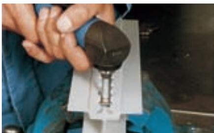
Especiales para limpieza y lijado de ranuras, por ej., limpieza de carriles de fijación de los asientos de los aviones y eliminación de óxidos.
