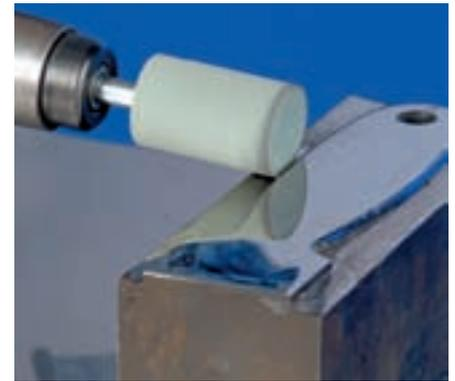
Las herramientas de afinado Poliflex® de aglomerante PUR se fabrican con carburo de silicio (SiC) verde. El aglomerante PUR es un aglomerante muy blando que está disponible en dos durezas PUR-W y PUR-MH.
