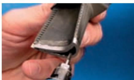
Fresa cilíndrica según DIN 8032 con dentado periférico y frontal según DIN 8033.
