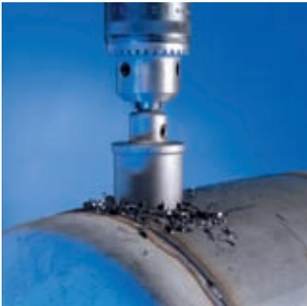
Las coronas de metal duro son herramientas profesionales para el serrado rápido y exacto de agujeros (orificios) entre 16 y 105 mm de diámetro. Son adecuadas para el trabajo de aceros aleados y sin alear, acero fino (INOX), metales no férricos y plásticos (incluso GFK). Se utilizan en taladradoras portátiles o máquinas estacionarias.
