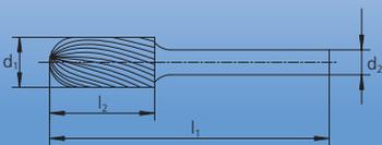
Forma uso universal, dada la combinación de geometrías cilíndricas y esféricas según DIN 8032.
