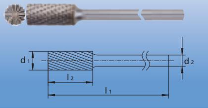
Forma cilíndrica según DIN 8032 con dentado periférico y frontal según DIN 8033.
