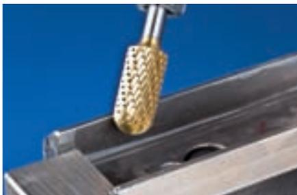
Fresa cilíndrica DIN 8032 con dentado según DIN 8033.
