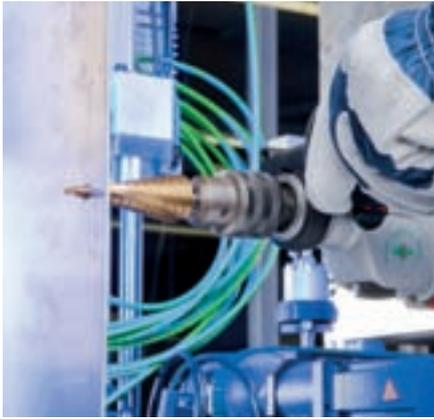
Herramienta robusta de alto rendimiento para taladrar sin rebabas y desbarbar chapas, tubos y perfiles. Materiales hasta un espesor de 4 mm. Se pueden taladrar y desbarbar en un solo paso con mínimo desgaste. El recubrimiento de alta calidad es resistente al desgaste y de uso universal en el trabajo de acero, fundición, acero fino (INOX), metales no férricos, termoplásticos y duroplásticos.
