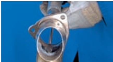
Fresa forma llama según ISO 7755/8 con dentado según DIN 8033.
