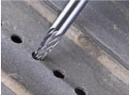
Fresa cónica apuntada según DIN 8032 y dentado según DIN 8033 (dentado), punta achatada.
