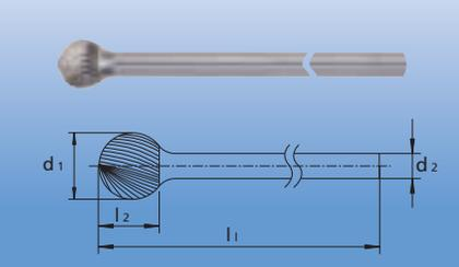
Forma esférica según DIN 8032 con dentado periférico y frontal según DIN 8033.
