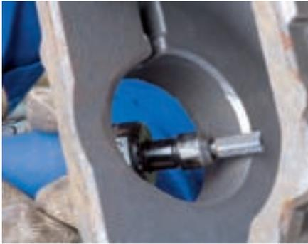
Fresa cilíndrica según DIN 8032 con dentado periférico y frontal.
