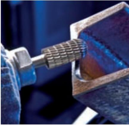
Gracias a su especial geometría de dentado y a la alta calidad de fabricación, las muelas HSS son especialmente adecuadas para desbarbar, achaflanar, limpieza de fundición y para el mecanizado de aluminio. También pueden usarse adecuadamente con máquinas de baja potencia en el nivel de revoluciones bajo.
