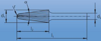
Fresa cónica con cabeza redonda según DIN 8032.
