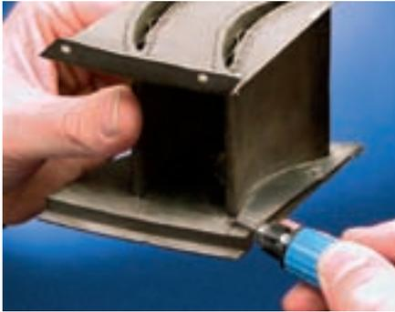
Fresa esférica DIN 8032 con dentado según DIN 8033.
