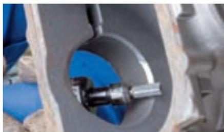
Forma cilíndrica según DIN 8032 con dentado periférico según DIN 8033.
