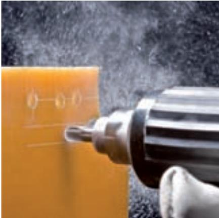
Las fresas de metal duro con dentado FVK y FVKS son apropiadas para el canteado y fresado de contornos del amplio abanico de plásticos reforzados con fibra GFK y CFK.
