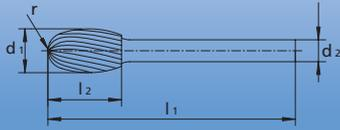
Fresa forma gota según DIN 8032 con denta-
