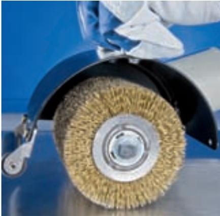
Herramienta especialmente adecuada para la estructuración de superficies de grandes piezas de calderería.
