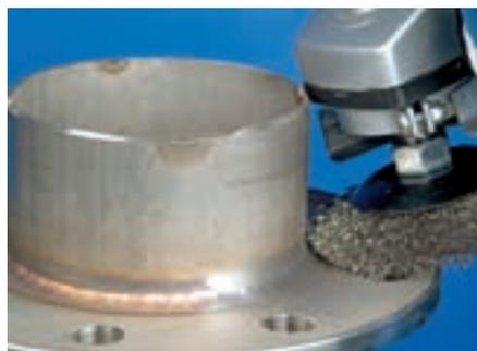
Especialmente adecuadas para trabajos semipesados, para desbarbar, limpiar y eliminar herrumbre. La forma cónica de la carda facilita el trabajo sobre puntos de difícil acceso, por ej., cantos interiores, canales y ranuras.
