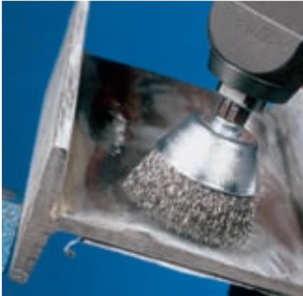
Uso universal para limpiar, desbarbar, alisar, descascarillar y eliminar corrosión y lacas.
