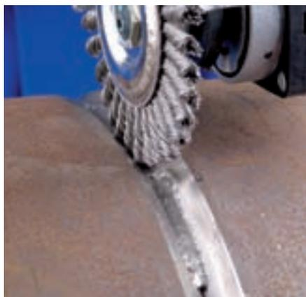
Adecuadas para trabajos pesados en la construcción de tuberías (Pipeline) y depósitos.
