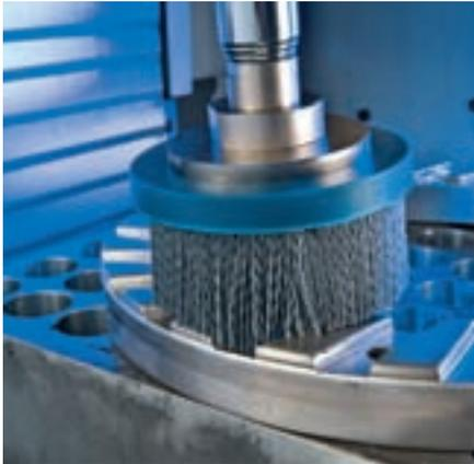
Especialmente adecuadas para desbarbar y para el mecanizado de superficies en máquinas estacionarias.
